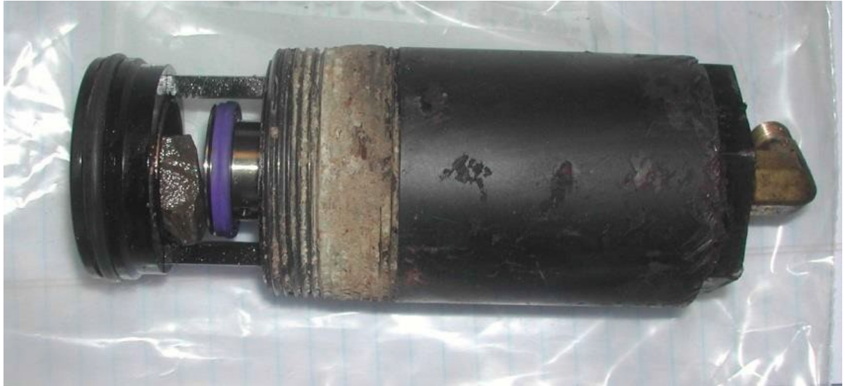
Piedra colocada para desactivar el detector de fugas en la línea
