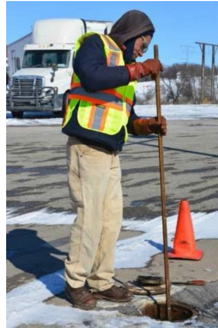
Se mide el nivel de líquido en un tanque al principio y al término de un período de tiempo establecido.
