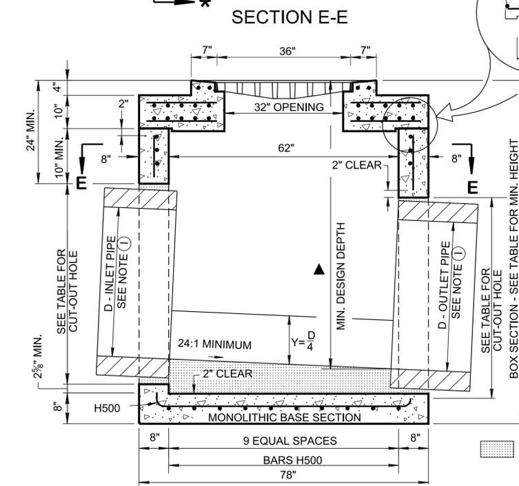
NON-SHRINK GROUT PER STANDARD SPECIFICATIONS SECTION 921 REQUIRED AROUND PIPE OPENINGS ONLY
