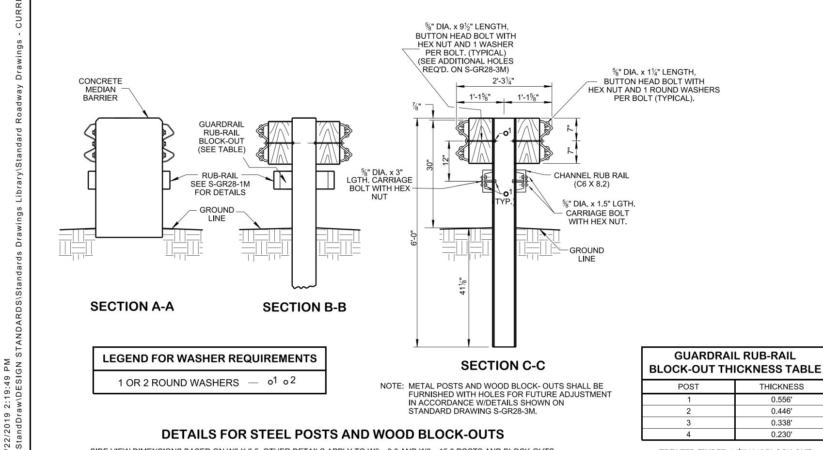
**DETAILS FOR STEEL POSTS AND WOOD BLOCK-OUTS**
